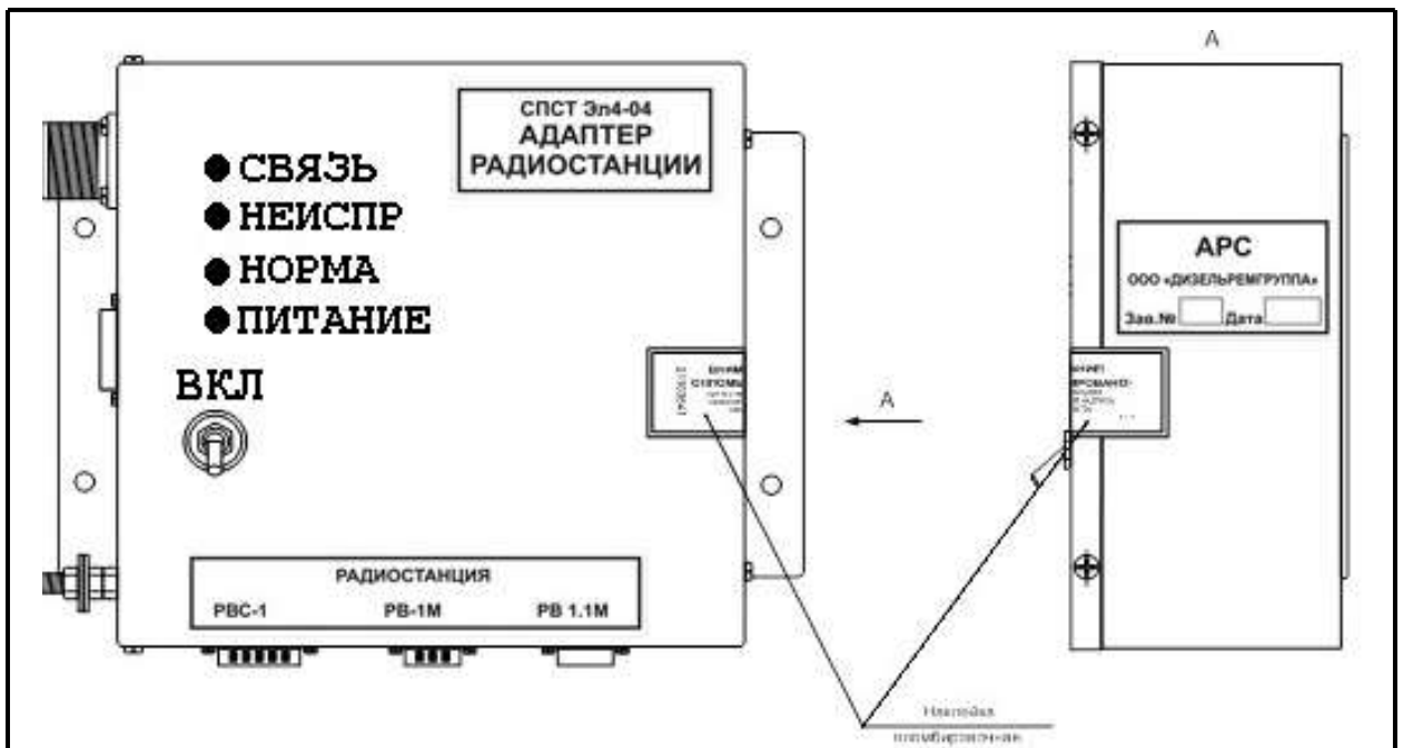
Рис. 13.4 - Пломбирование блока АРС
